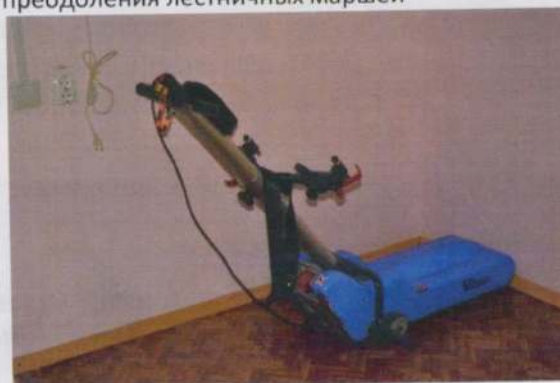
Фото № 8. Гусеничный подъемник для преодоления лестничных маршей
